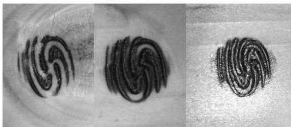
Рисунок 2 – Распределения интенсивности, формируемые CO 2 лазером
