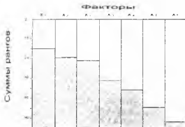
Рис. 1. Средняя априорная диаграмма рангов при изучении зависимости \alpha_{RC} RC-структуры от условий ее изготовления
