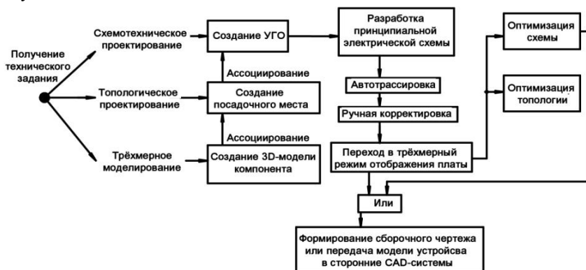
Рисунок 1 - Алгоритм разработки трёхмерной модели ПК
