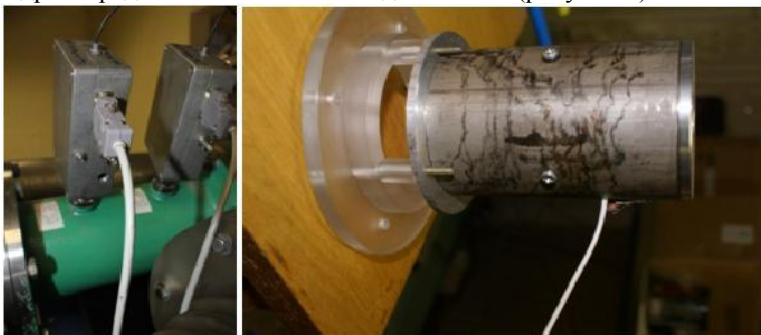
два цилиндра Фарадея, вставленные в тракт ускорителя с усилителями(слева); цилиндр Фарадея в экране (справа)
