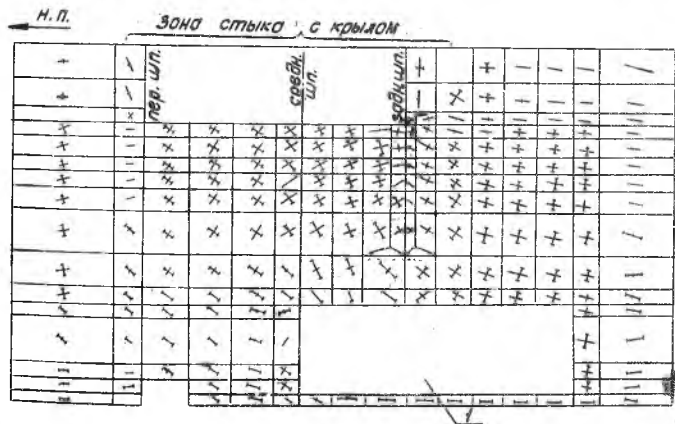
Р и с.4. Главные напряжения в обшивке фюзеляжа: I-вырез под пассажиром; — — растяжение; - - сжатие
