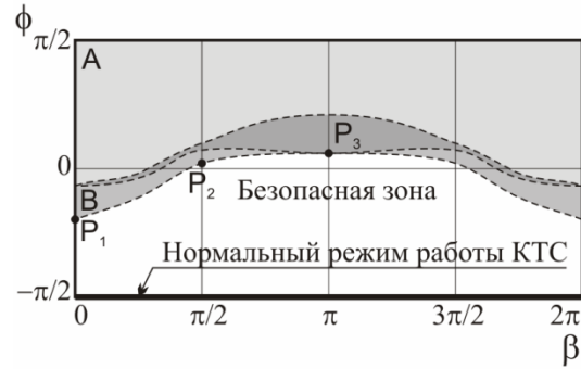
Рисунок 8 - Опасные зоны отделения и соответствующие им нештатные ситуации. А – груз переходит на более высокую орбиту, В – наматывание троса на КА
