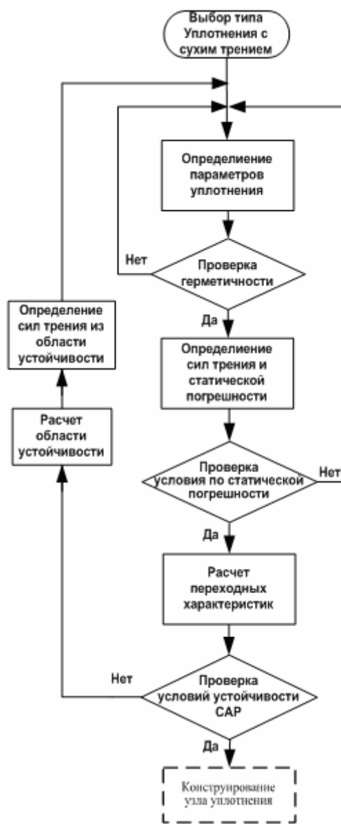
Рисунок 10 – Основные этапы методики определения параметров уплотнительных элементов регулятора
