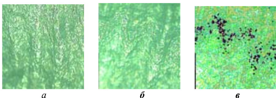
Рис.28. Волновая природа сдвиговых деформаций при многоцикловом нагружении
