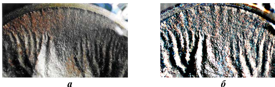
Рис.27. Волновая поверхность усталостной макротрещины по типу I
