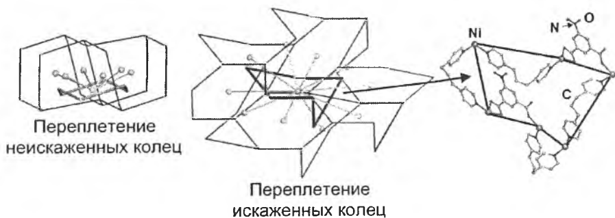
Рис. 9. Переплетение неискаженных (слева) и искаженных (в центре и справа атомы водорода для наглядности удалены) колец двух взаимопроникающих базовых сеток dia по мотиву 6,10-координированной КСХ (большие светлые шары) в [\text{Ni}(\text{H}_2\text{O})(\mu_2\text{-dppn})(\mu_2\text{-niph})] ( dppn = 1,3-ди(4-пиридил)пропан, niph = 5-нитроизофталато) [LAYKOM]
