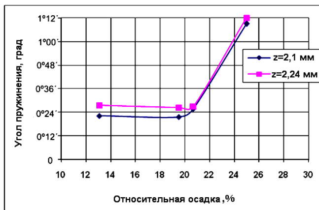
Рисунок 7 - Зависимость пружинения от относительной осадки полиуретанового пуансона при r = 2 мм, s = 2 мм (материал АМг6М)
