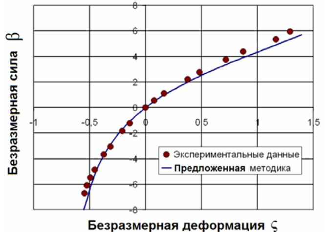
Рис. 14. Сравнение результатов расчёта характеристик образца (рис. 13) с экспериментальными данными
