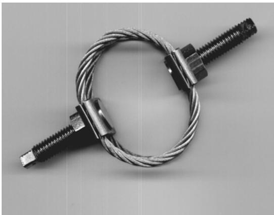
Рис. 13. Один из экспериментальных образцов тросового виброизолятора с радиусной формой УДЭ
