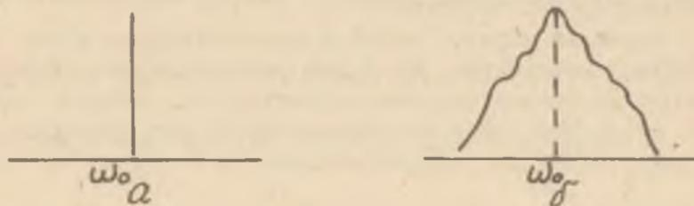
Р и с. 5. Спектр автоколебания в случае полной фазовой компенсации (а) и в случае стохастизации режима (б)
