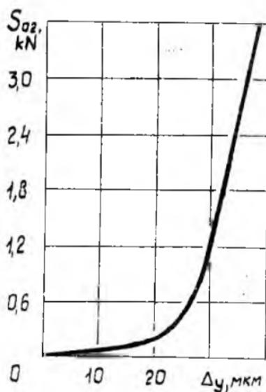
Р и с. 4. Экспериментальная зависимость сближения элементов КУ от контактной нагрузки
