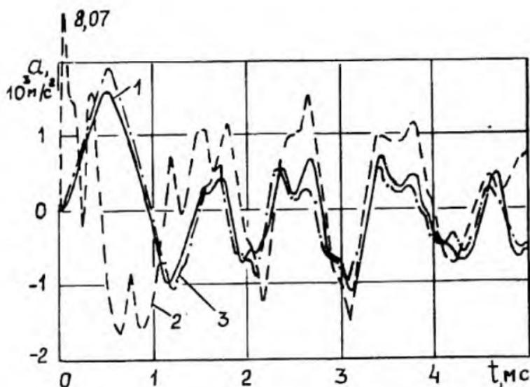
Р и с. 3. Временные зависимости вибраций корпуса пневмогидроклапана
