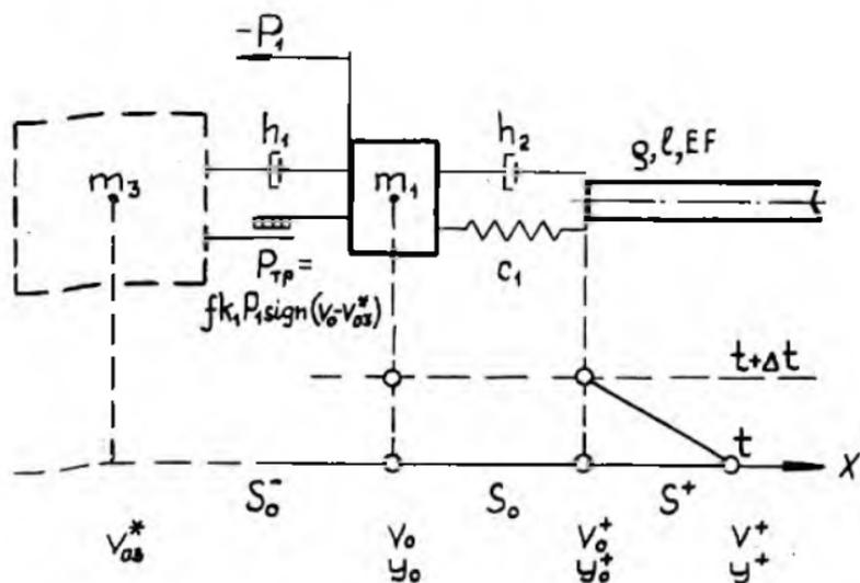
р и с. I. Расчетная схема подсистемы управления пневмогидроклапана (пневмопривод)
