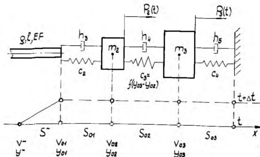
Р и с. 2. Расчетная схема подсистемы КУ с корпусом пневмогидроклапана
