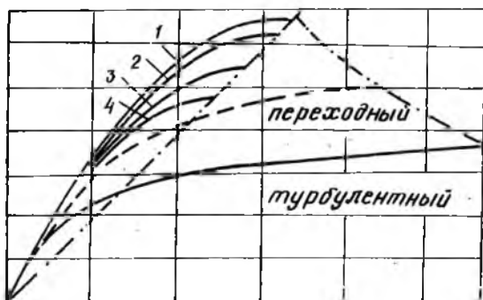
Рис. 2. Динамика развития течения в трубе: 1. Re_{кр1} = 2200 ; 2. Re = 2000 ; 3. Re = 1800 ; 4. Re = 1200 .
