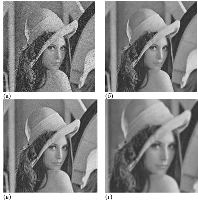
Рис. 1. (а) зашумленное изображение, (б) изображение, восстановленное с помощью разреженного представления, (в) изображение, восстановленное с помощью преобразования Фурье, (г) изображение, восстановленное с помощью байесовского подхода
