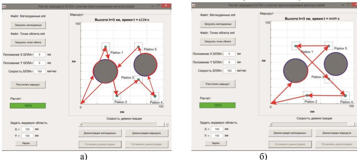
Рисунок 2. Варианты применения БЛА в сложных метеоусловиях: а) Традиционная модель применения БЛА в СМУ; б) Предлагаемая модель применения БЛА в СМУ.
