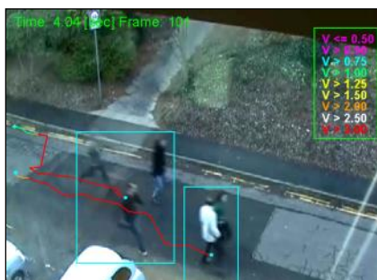
Рис. 1. В поле зрения программы интеллектуального видеонаблюдения попала ситуация, похожая на уличный инцидент (нападение группы хулиганов). Прямоугольниками обозначены движущиеся блобы, жирными линиями обозначены связанные графы перемещений блобов. Скорость движения блобов обозначена с помощью цвета рёбер графа.
