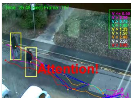
Рис. 2. Программа интеллектуального видеонаблюдения распознала уличный инцидент. Жёлтыми прямоугольниками обозначено текущее положение участников происшествия. Остальные обозначения такие же, как на рис. 1.
