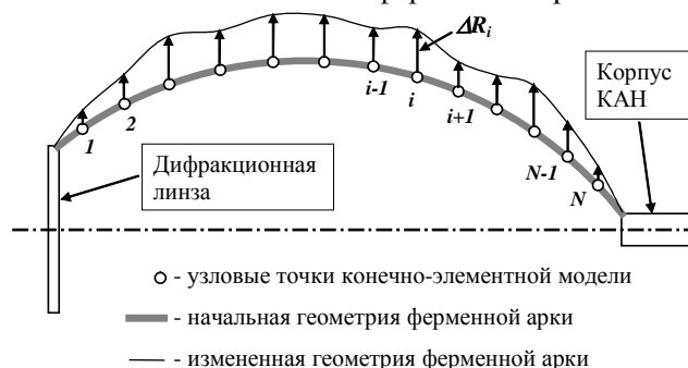
Рисунок 6. Геометрия конструкции крепления дифракционной линзы КАН до оптимизации (а) и после незавершенной процедуры оптимизации (б).
