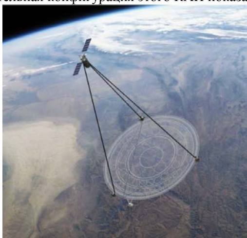
Рисунок 1. Проект геостационарного космического аппарата с мембранной оптической системой (MOIRE - Membrane Optical Imager for Real-Time Exploitation)[1-3].
