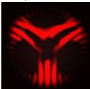
**Рисунок 4.** Распределение интенсивности после модулятора для  $a = 6.3$ .
