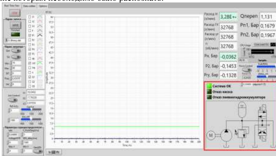
Рисунок 4. Графические интерфейс модуля управления и мониторинга состояния ЭГМС на платформе LabView.
