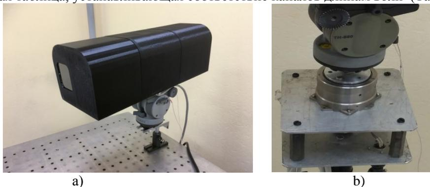
**Рисунок 1.** Внешний вид макетного образца изображающего гиперспектрометра на основе схемы Оффнера - (а) и вид вращающейся платформы (б).
