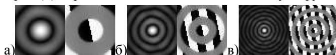
Рисунок 1. Амплитуда и фаза поля U(x, y) при k_t : 5 – (а), 10 – (б) и 20 – (в).
