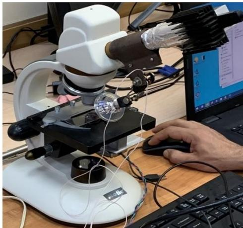
Рис. 1. Внешний вид микроскопа с гиперспектральной приставкой
