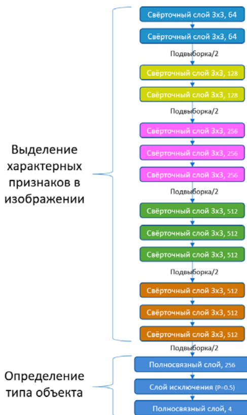
Рисунок 5. Архитектура сверточной сети VGG-10 для исследования.
