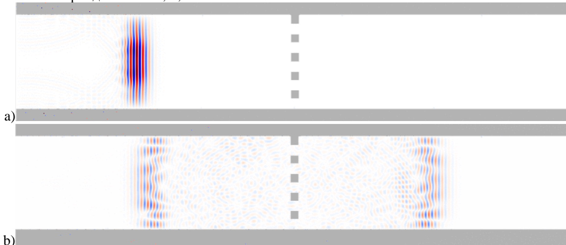
Рисунок 4. Прохождение импульса через решетку при T = 2\lambda : а) t=50 фс б) t=200 фс.
