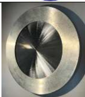
Рисунок 2. Фото изготовленного аксикона.
