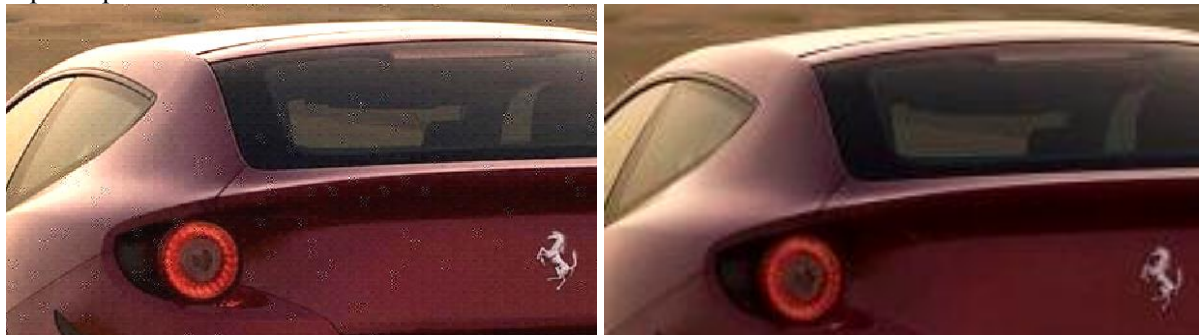
Рисунок 8. Визуализация искажений, вызванных встраиванием ЦВЗ: слева – встраивание в компоненту яркости, PSNR=32,69; справа – встраивание компоненту Cr, PSNR=38,83.
