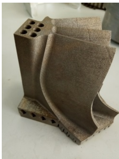
Рисунок 1. Образец для калибровки, приближённый к условиям выращивания итогового изделия.
