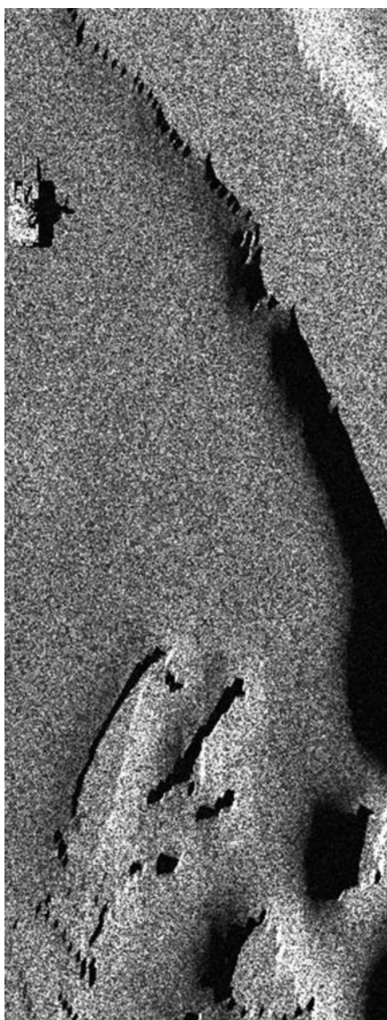
Рис. 3. Смоделированное изображение с наложенным спекл-шумом
