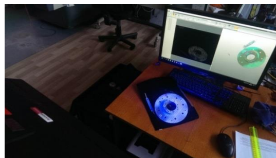
Рисунок 6. Измерение группы сканов детали.
