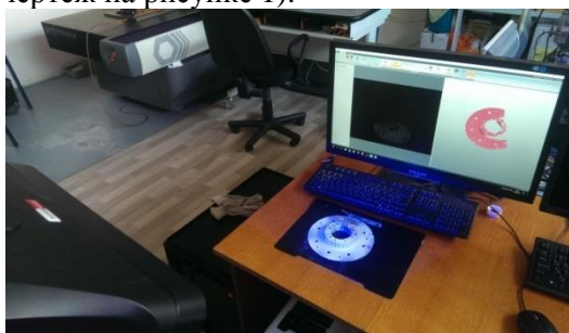
Рисунок 5. Измерение одного скана детали.
