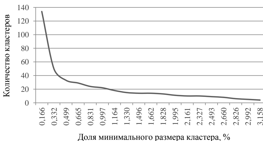
Рисунок 5. График зависимости количества кластеров от параметра доли минимального размера кластера относительно площади сегментируемого изображения.
