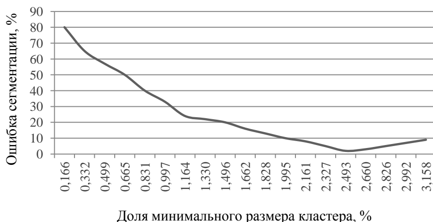
Рисунок 6. График зависимости ошибки от параметра минимального размера кластера относительно площади сегментируемого изображения.
