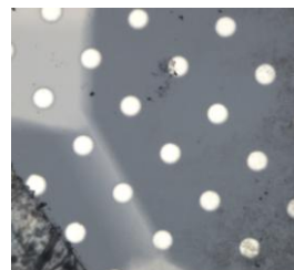
Рисунок 4. Снимок образца ПЛ4 с массивом нанесенных контактов Шоттки.
