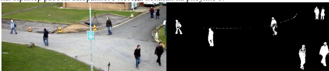
Рисунок 1. Выделение движущегося человека на видеопоследовательности: кадр исходной видеопоследовательности (слева), сформированная маска (справа) [10].
