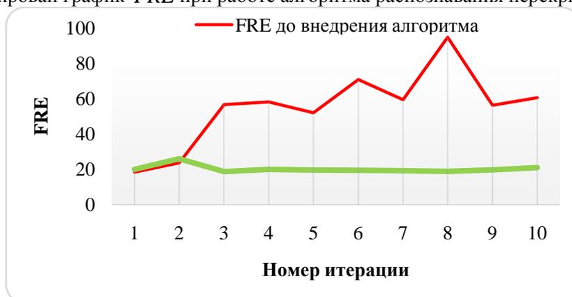
**Рисунок 6.** Снижение значения показателя качества FRE при обнаружении перекрытий по предложенному алгоритму.
