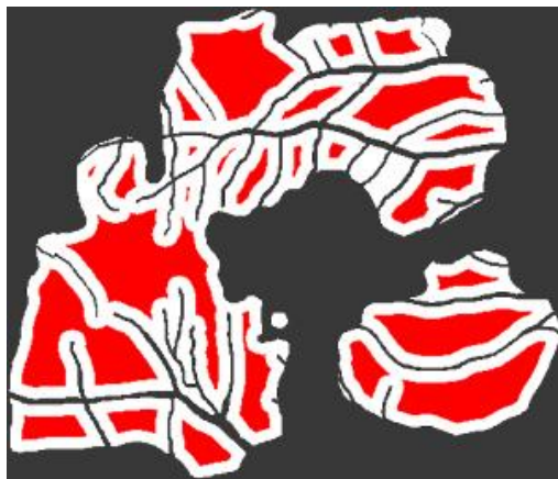
Рис. 2. Изображение потенциальных центров шаров (красная область), полученное из исходного изображения (белая область).
