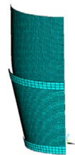
Рисунок 4. Модель с разбиением деформирования на конечные элементы.
