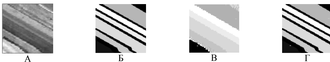
Рисунок 2 – Экспериментальные исследования на малом фрагменте Салинаса А) исходное изображение, Б) заданная классификация изображения, В) результат классификации с использованием показателя сопряженности, Г) результат классификации без незамеченной области
