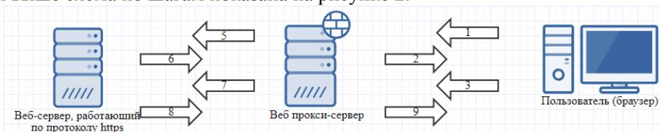
**Рисунок 2.** Схема работы веб-фильтра с HTTPS-трафиком.
