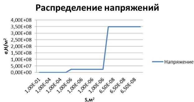
**Рисунок 5.** Распределение напряжений по длине троса системы Фобос-Марс.
