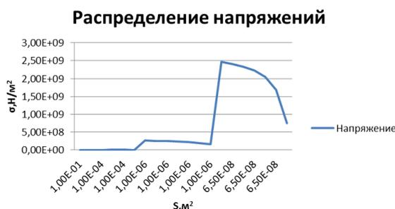
**Рисунок 3.** Распределение напряжений по длине троса системы Земля-Луна.
