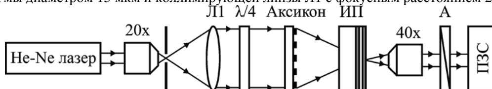
Рисунок 3. Схема экспериментальной установки для получения радиально-поляризованных пучков Бесселя нулевого порядка.
