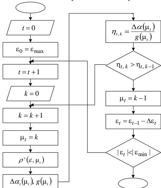
Рисунок 1. Блок-схема алгоритма нахождения оптимального объема локальной выборки.
