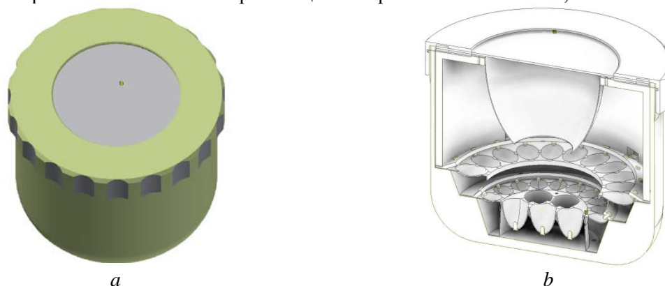
Рисунок 2. Взлётно-посадочный прожектор самолёта: a – внешний вид прожектора; b – сечение прожектора.
