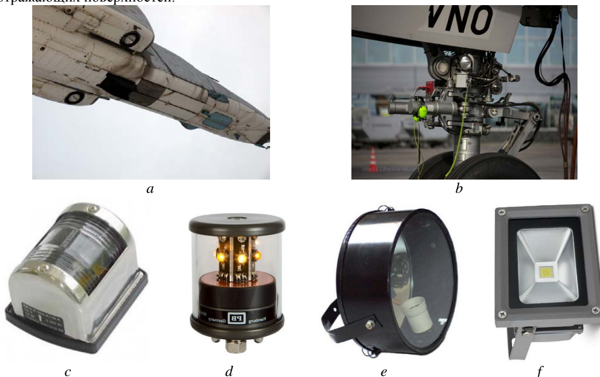
Рисунок 1. Осветительные устройства различного назначения: a - посадочно-рулëжная фара самолёта; b - взлётно-посадочная фара самолёта; c - корабельный навигационный фонарь; d - сигнальные судовые огни; e - строительный прожектор с лампой накаливания; f - светодиодный строительный прожектор.
