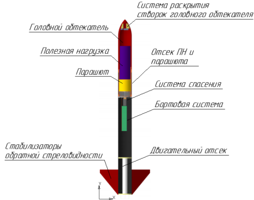
Рисунок 1 – Проектный облик ракеты SODA1
