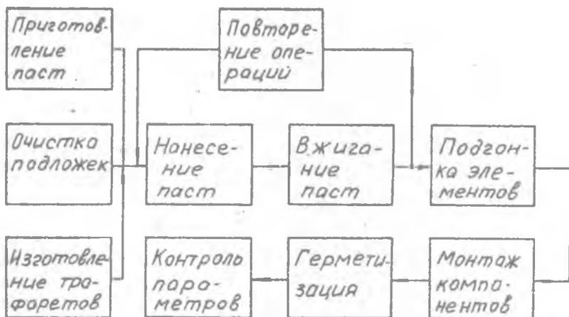
Рис.2. Схема технологического процесса изготовления толсто пленочных микросхем
