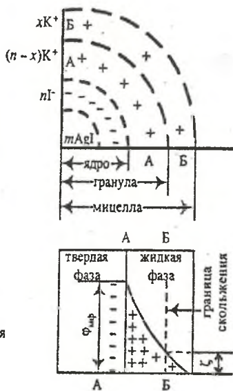
Рис.1. Схема строения мицеллы иодида серебра в избытке иодида калия
