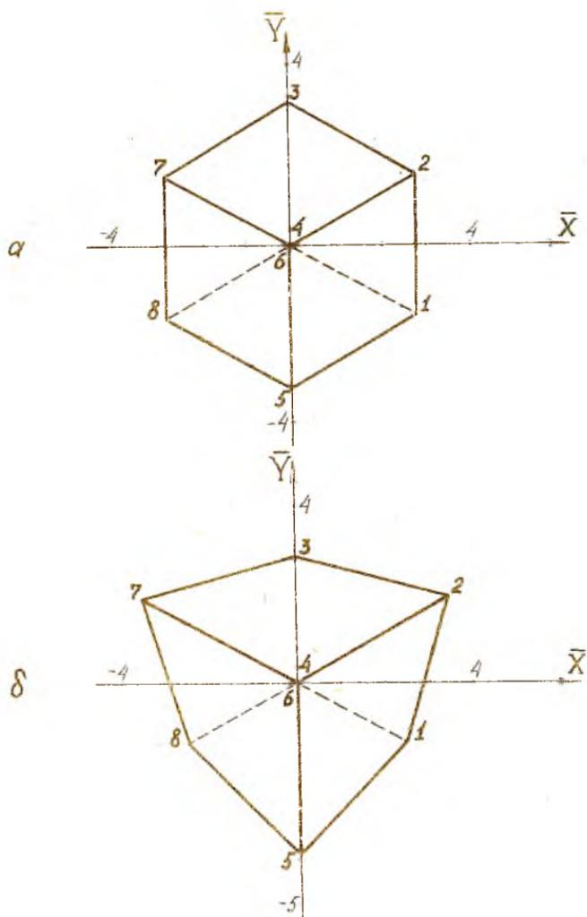
Рис. Результаты геометрических преобразований в графическом виде:  $\alpha$  - ортогональная проекция,  $\delta$  - центральная проекция
