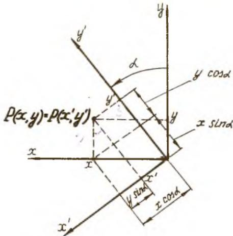
Р и с.3. Поворот системы координат вокруг оси  $z$
