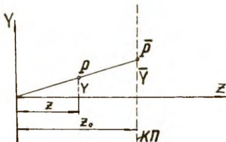
Р и с.2. Определение координат при центральном проецировании
