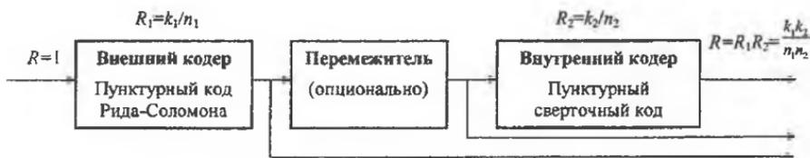
Рис. 17. Схема канального FEC-кодирования
