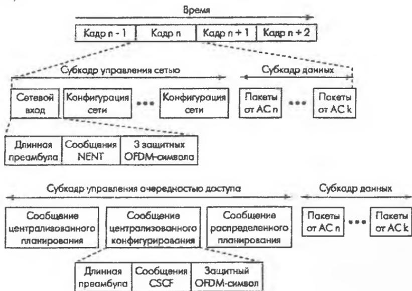
Рис. 26. Структура кадра Mesh-сети с вариантами управляющих субкадров
