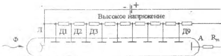
Рис.2. Схема питания диодов
