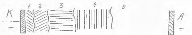
Р и с. 9. Структура тлеющего разряда: 1 - катодное свечение; 2 - темное катодное пространство; 3 - отрицательное свечение; 4 - Фарадеево темное пространство; 5 - положительный столб
