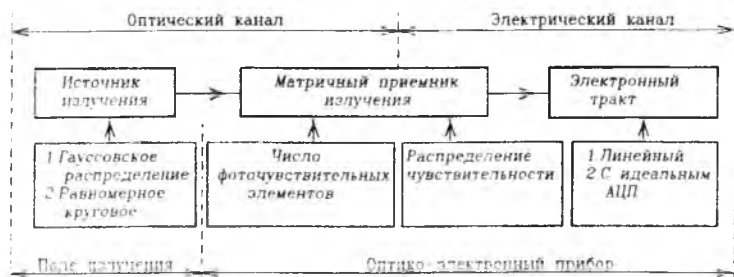
Рис 2. Упрощенная структурная схема ОЭП с МФПУ
